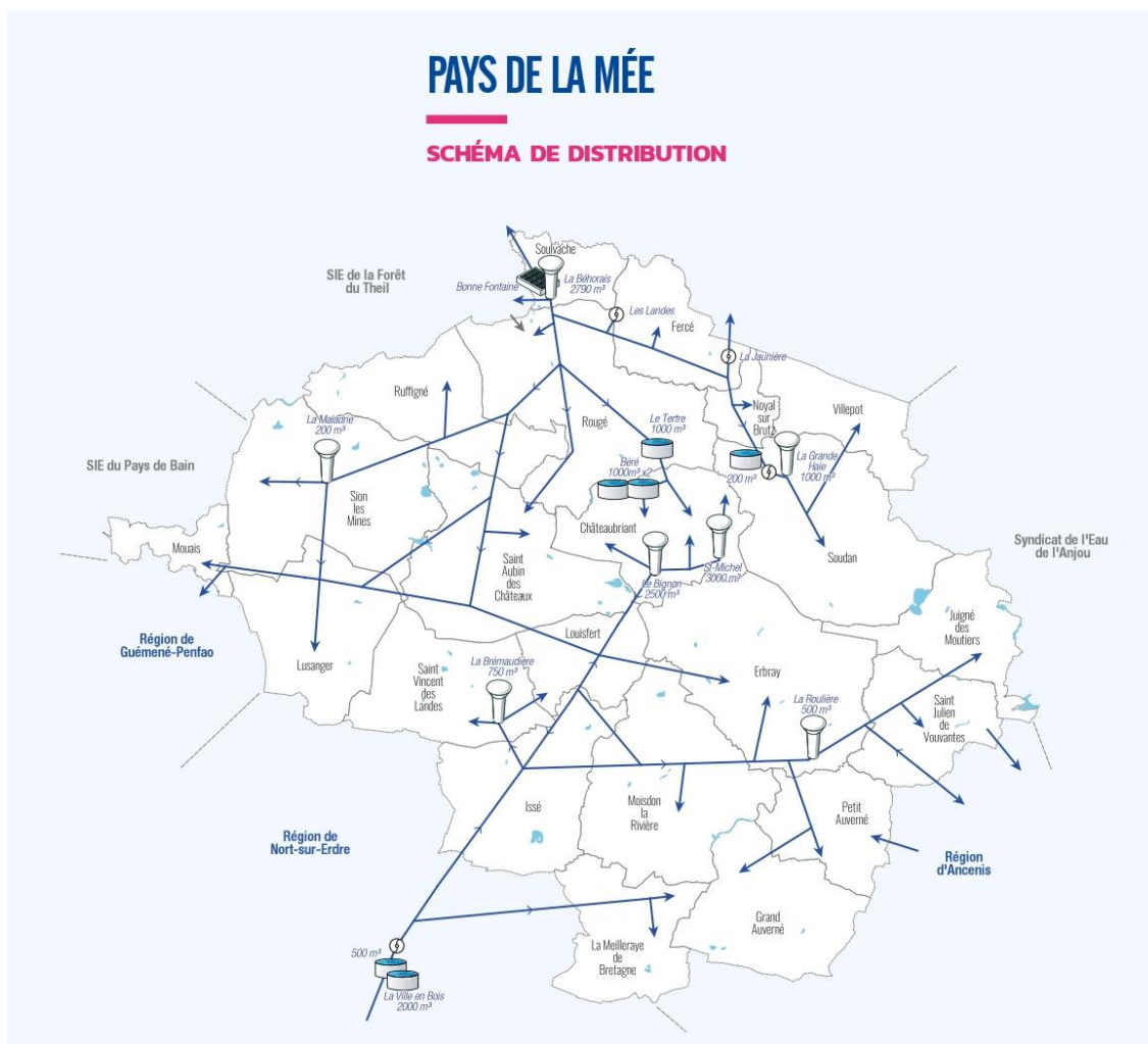
Document 1 - Schéma de l'alimentation en eau potable du Pays de la Mée
